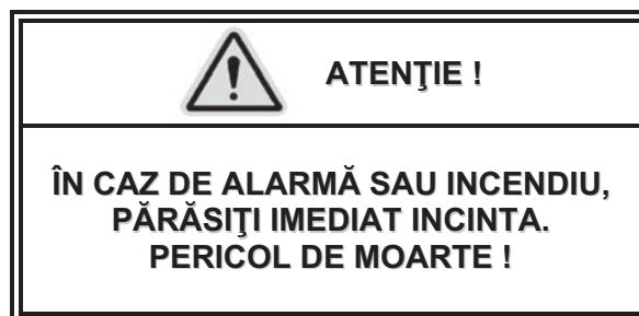
Figura 2.1. Indicator pentru avertizare asupra faptului că spațiile sunt protejate cu substanțe speciale de stingere
